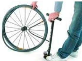
●チューブをかまないために、タイヤをはめる前に軽く空気を入れよう。チューブが丸くなる程度で十分
