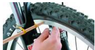
●ディスクのMTBはシューでフレを見ることができないので、割り箸と輪ゴムを使おう。2本あれば、左右同時に見られる
