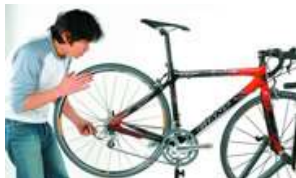
●クイックを何度か締め直し左右のクリアランスを見ると同時にホイールのフレも見
