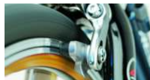
●シューを片方に寄せてホイールを回すと、リムとシューの間隔でどこがフレしているかわかる。フレは左右均等に見てとっていく
