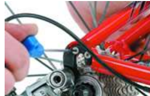
●リプレーサブルエンドのネジが緩んでいる場合があるので、調整前にチェックしよう
