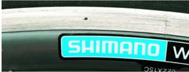
●ラベル近くに見える小さなポッチが分からなくなったら、ホイールの交換時期だ
