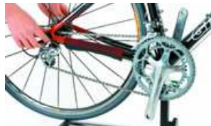
●クイックを締めるのに車輪が宙に浮いた状態だと同じ位置に決まりづらい。必ず着地した状態で
