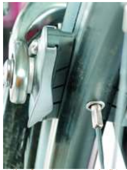
●後ろブレーキのリムサイド。進行方向側が先に効き始めるように調整しよう。ブレーキによっては、調整できない種類もある
