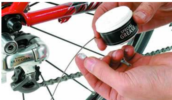
●ワイヤ固定ボルトを5mmアーレンキーで緩め、アウターワイヤをずらす。グリスをまんべんなく引き伸ばしてつける
