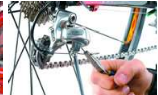
●ワイヤはベンチで引っ張りながら止めよう。ワイヤの初期伸びが1回出てしまえば、何度も調整し直すことはなくなる
