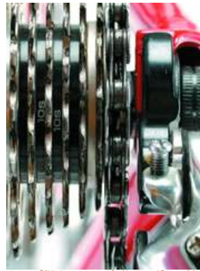
●トップ側はチェーンが2枚目のギヤに触れていないか見る。触れている際はHの印のある調整ネジを反時計回りに回すと外側に動く
