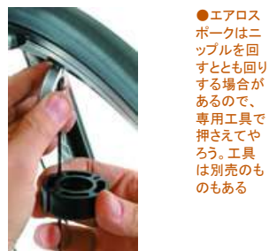
●フリ取りの前にひと通りスポークを手でしごいてやると、なじみが出て実際のフレが出る。フレを取り終わったあとも同様にしよう
