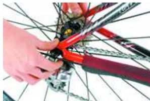
●後輪も左右逆に入れてクリアランスを見る。チェーンで右チェーンステーをキズつけないように
