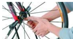
●フリ取りの前にひと通りスポークを手でしごいてやると、なじみが出て実際のフレが出る。フレを取り終わったあとも同様にしよう
