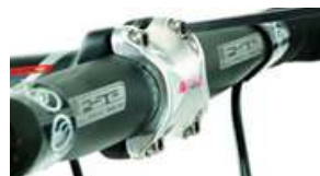
●ステムのネジはクランプとステムの間隔を上下均等に締めよう。そうしないと、ネジ
